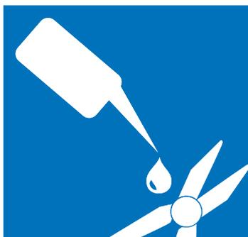
Treatare il perno e gli inserti in tungsteno della pinza con olio lubrificante (REF: 055-201-00).
